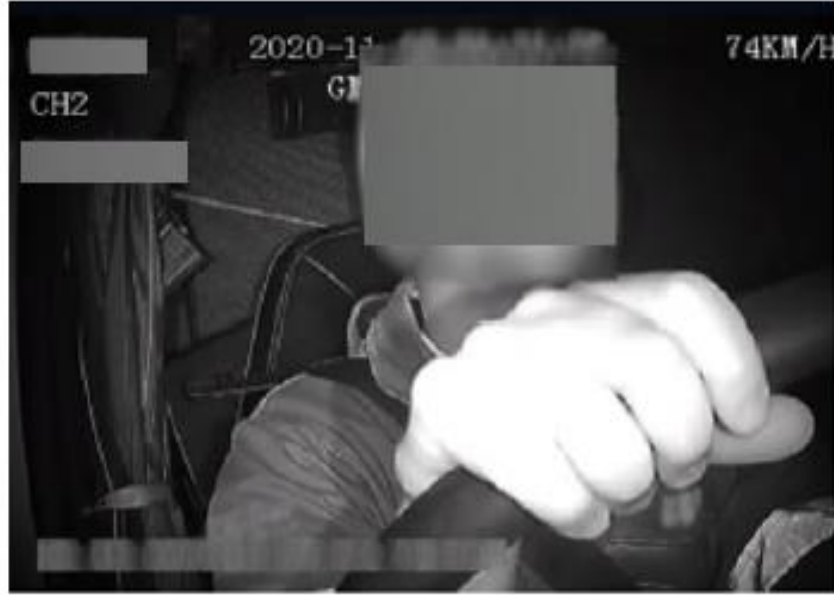
Tavsiye edilmeyen DSM kurulum görüşü (direksiyon simidi tarafından engellenen geniş görüş) X
